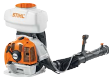
SR 440 63,3 CM*, 2,9 KW/3,89 HP, 20 L, 12,2 KG*. Potente fumigadora de gran alcance. Con depósito de 20 L y motor 2 Mix, sistema de arranque simplificado, correas cómodas y empuñadura multifuncional de una mano. De serie con rejilla cónica de desvío, rejilla de desvío y rejilla de doble desvío.
